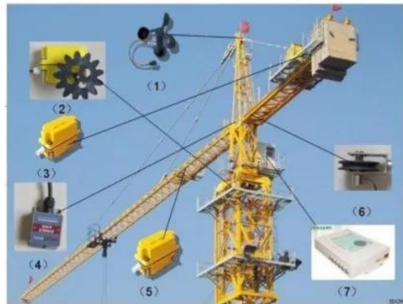
(1) 风速传感器 (2) 角度传感器 (3) 高度传感器 (4) 轻角传感器 (5) 幅度传感器 (6) 重量传感器 (7) 检测仪主机
