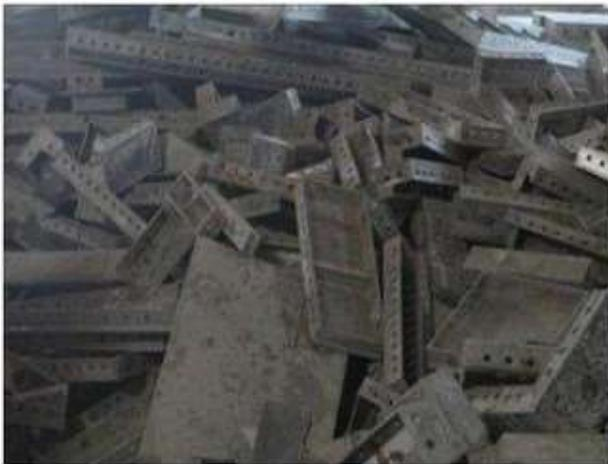
铝模拆模型材磕碰变形，表面未清理
