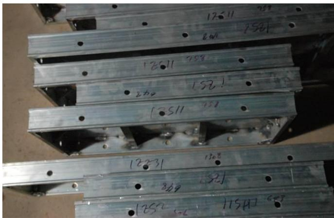
➤ 定型小块板在边框上标有字母“W”代表是墙板，“E”代表是梁底。铝合金厚4-8mm，尺寸定型化，图中398mm\*1198mm。
